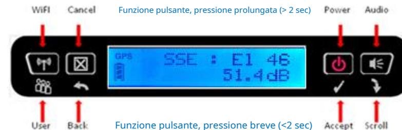
5. Installare l'UT in un'area aperta e consentirgli di acquisire un fix GPS. Le icone dei satelliti GPS sul display indicheranno quando l'UT può vedere i satelliti GPS. L'icona GPS diventerà fissa e le icone dei satelliti scompariranno quando l'UT avrà una correzione.
