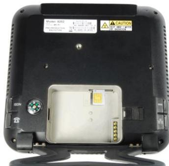
3. Installare la batteria e caricarla completamente prima di utilizzare il terminale.
