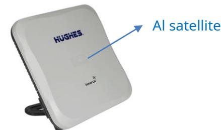
7. Massimizzare il segnale visualizzato sul display LCD regolando la direzione e l'angolo di elevazione dell'unità. È inoltre possibile premere il pulsante audio per ottenere un'indicazione acustica del segnale. La potenza del segnale dovrebbe essere compresa tra 50 e 54 dB.
